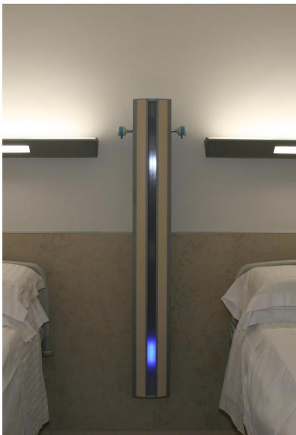
STILOS è unità verticale per uno o due posti letto, composta da un insieme di profili di alluminio estruso, assemblati con una copertura frontale in laminato ad alta pressione in varie finiture e, a scelta, con inserto centrale in metacrilato retroilluminabile con LED; l'intensità della luce può essere regolata con vari sistemi di dimmerazione.
